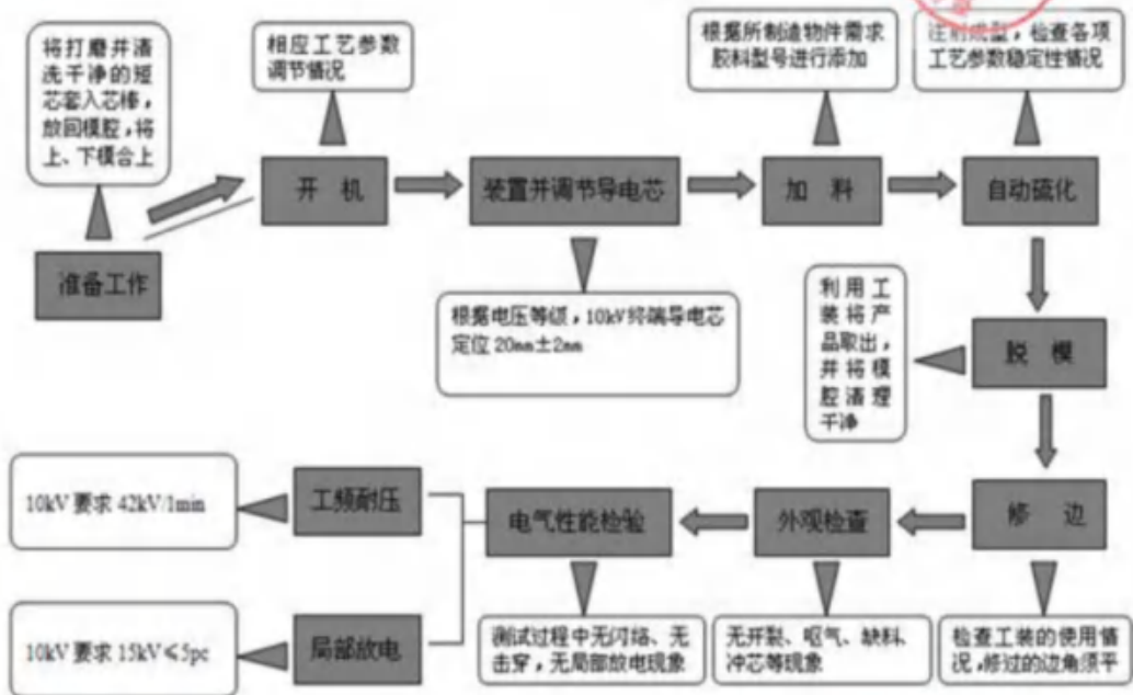
10kV 户内（外）终端制造工艺流程和质量控制要点示意图
